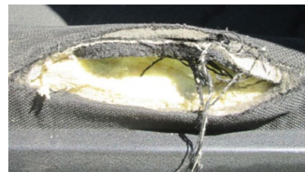
Schiuma mancante o telaio rotto
