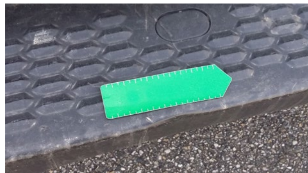
Pedane posteriori: Leggera deformazione
