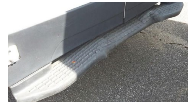
Pedane posteriori: deformazioni dalla riparazione antieconomica
