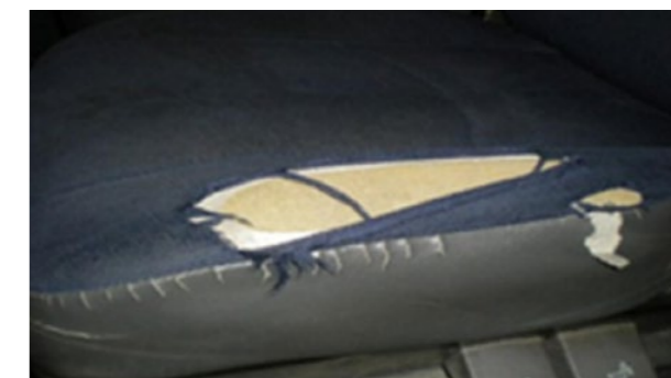
Bruciatura > 3 mm, perforazione o strappo nella copertura, senza deterioramento della schiuma
