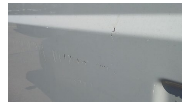
Graffi > 20 mm Nota: sulle porte a battente posteriori non è possibile applicare vernice per metà del battente
