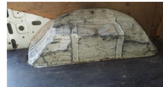
Deformazioni interne: Perforazioni, tagli, deformazioni dalla riparazione antieconomica. Depositi di materiale snaturanti e non correggibili (polvere, vernice, ecc.) (Passaruota non recuperabile con tempo di riparazione < 3h)
